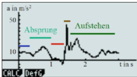
Abb. 1: Sensoranzeige beim Sprung vom Tisch: Vor dem Sprung (blau) wird 9,81 m/s<sup>2</sup> angezeigt. Beim Absprung (türkis) holt der Springer aus. Während des freien Falls (rot) meldet der Sensor a=0, obwohl der Springer mit -9,81 m/s<sup>2</sup> nach unten beschleunigt wird. Der Aufprall (braun) führt trotz des Abfederns mit den Beinen zu einer Beschleunigung von etwa 4 g. Beim Aufstehen (grün) pendelt sich allmählich die Ruheanzeige 9,81 m/s<sup>2</sup> wieder ein.
