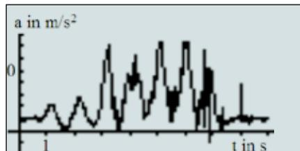
Abb. 4: Der Sensor war in einem geschleuderten Eimer, seine Koordinatenachse zeigte vom Eimerboden weg. Er zeigt  $a > 0$  an, also eine Kraft  $F = m \cdot a$  zur Drehachse hin.
