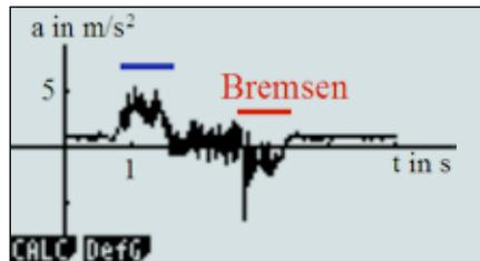
Abb. 3: Beim Anfahren misst der Sensor  $a > 0$  (blau), während er beim Bremsen  $a < 0$  anzeigt. Dennoch wird beim Anfahren eine Kraft nach hinten subjektiv wahrgenommen.
