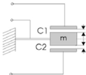
Abb. 2: In einem Beschleunigungssensor deformiert eine Masse m unter dem Einfluss von Kräften oder Trägheitskräften die Aufhängung und verursacht dabei ein elektrisches Signal. Nach diesem Prinzip funktioniert auch der Sensor, der im Auto den Airbag auslöst.
